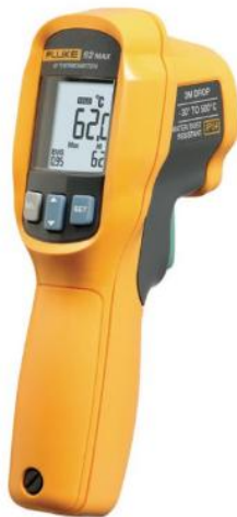
Abbildung 16: Fluke 62 Max für Schienentemperaturmessungen von Hand im Gleis
