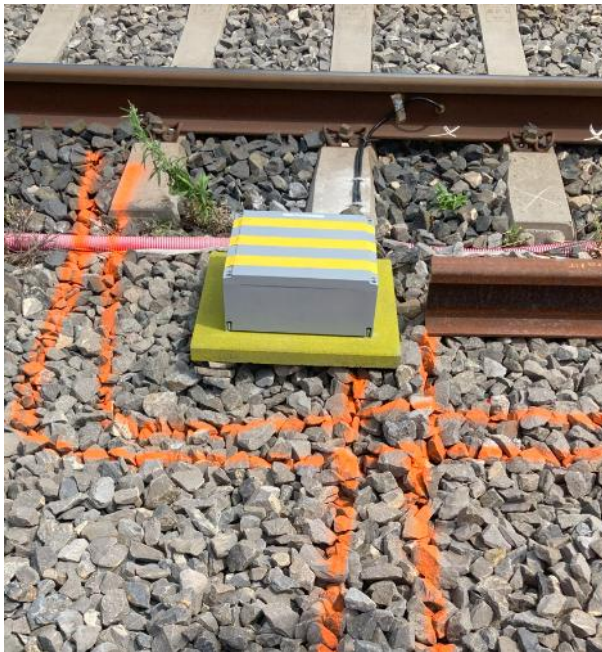
Abbildung 18 Schienensensoren Chiasso (mit Referenzschiene rechts)
